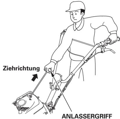
6. Den Motor einige Minuten lang warmlaufen lassen. Wenn der Choke auf CLOSE gestellt worden ist, ihn allmählich in die Stellung OPEN bringen, während der Motor warmläuft.
